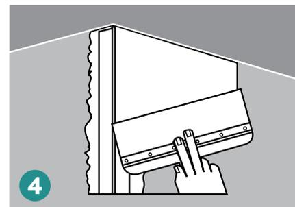
À l'aide d'un large couteau de finition, appliquer le composé tout usage sur une largeur d'environ 200mm (8") de largeur à partir de la bordure de papier.
