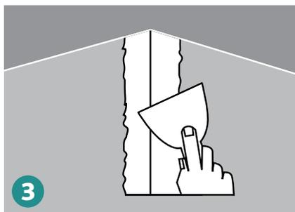
Enfoncer fermement la baguette d'angle dans le composé à l'aide d'un petit couteau de finition. Essuyer l'excès de composé sous le papier pour éliminer toutes les bulles d'air (faire attention de ne pas enlever tout le composé). Laisser sécher pendant au moins 24 heures.
