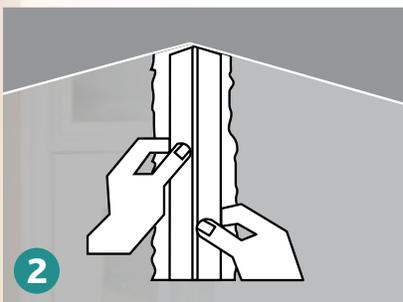
Couper la baguette d'angle à la longueur requise et placer sur le composé à joint en laissant 1/2" au bas pour permettre l'expansion et la contraction des éléments de charpente.
